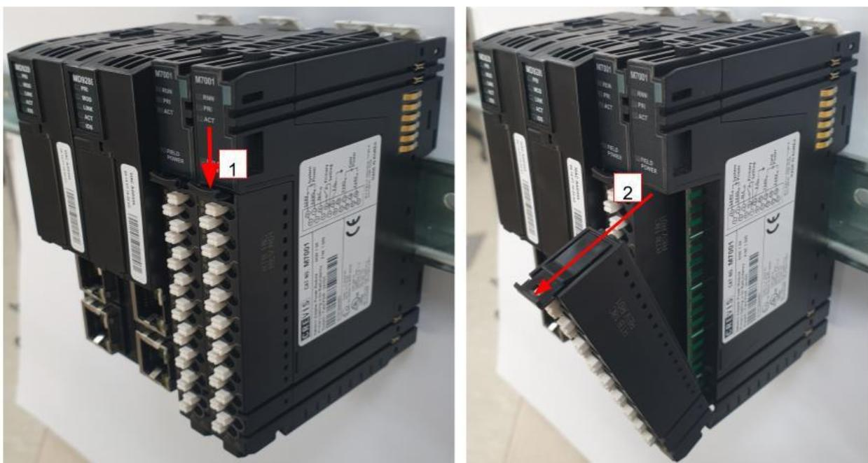
2) Нажмите на кнопку сверху модуля ввода/вывода или модуля питания и вытащите его по прямой линии.
