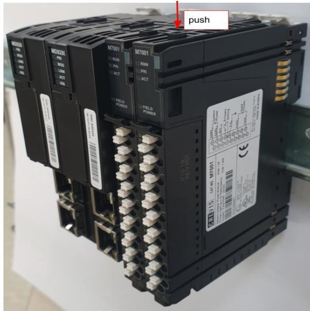
3) Держите новый модуль ввода/вывода или модуль питания за верх корпуса и осторожно вставьте его в базовый модуль.
