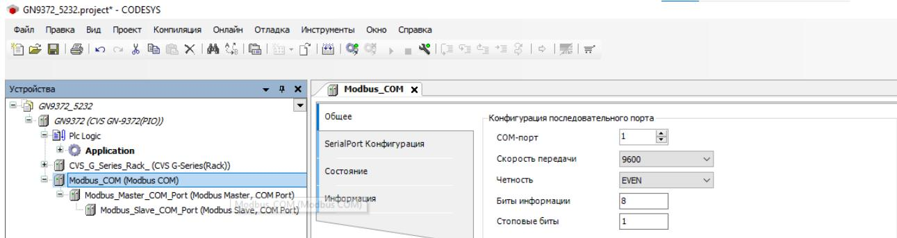
настроить параметры Modbus обмена (RTU / ASCII, таймауты),
